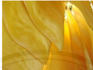
ภาพที่ 7 ยางแผ่นรมควัน (Ribbed smoked sheet, RSS)
